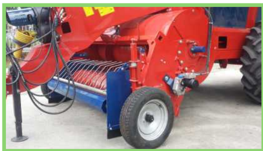
Greblă și rolă de colectare acționate hidraulic — Opțional
